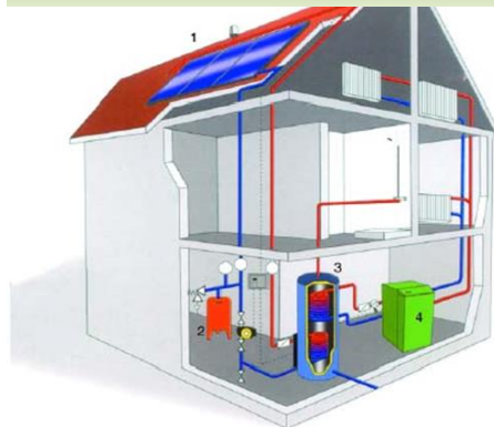
Система энерготеплоснабжения индивидуального дома на основе ВИЭ
